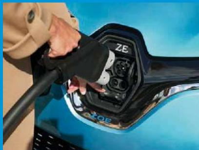
Quando ZOE è in carica, la quantità di energia recuperata in kW è maggiore quando la batteria è interamente o quasi scarica. La velocità di ricarica diminuisce poi progressivamente all'aumentare del livello di carica. La potenza di carica dipende anche dalla temperatura, dall'usura della batteria e dalla potenza rilasciata dal caricatore.
