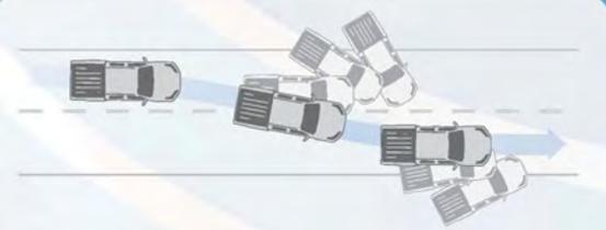
**Controllo dinamico del veicolo (VDC).** Il sistema VDC monitora la stabilità del veicolo e, se necessario, riduce la coppia motore e frena la ruota specifica per aiutarti a mantenere la traiettoria desiderata.
