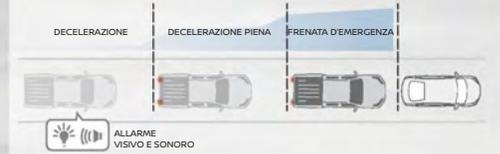
**Dispositivo frenata di emergenza (FEB).** Un radar integrato nel paraurti anteriore misura la distanza che ti separa dalla vettura che precede. Se individua il rischio di una collisione, emette un segnale sonoro e visivo. Se il conducente non reagisce, il dispositivo frena automaticamente il veicolo per evitare impatti.
